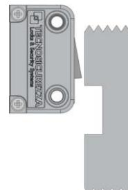
La carga máxima aplicable al pestillo no debe exceder 1KN. Contacte Tecnosicurezza en caso de cargas mayores.
