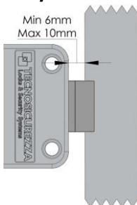
La distancia entre la cerradura SpringBolt y la barra de bloqueo debe ser de 6 mm como mínimo y máximo de 10 mm.
