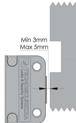
La cerradura Motor LatchBolt está diseñada especialmente para asegurar el autocierre cuando la puerta cierra.
