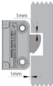
En la posición de cierre la distancia entre el pestillo SwingBolt y la parte que mueve el pestillo de la cerradura debe ser de aproximadamente 1 mm.
