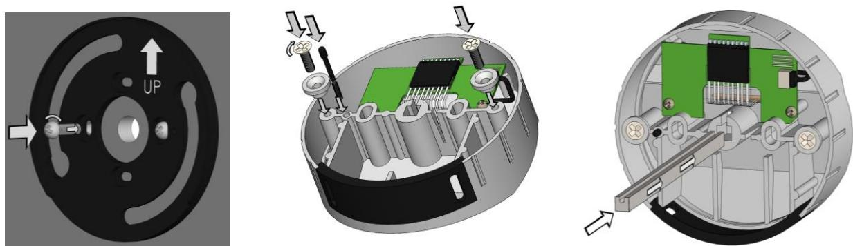
Fije los tornillos (M4) y la placa giratoria posterior, colocando esto último por el lado marcado "UP" (arriba). Fije los casquillos a la carcasa del teclado con los tornillos suministrados. Inserte el pin completamente en el muelle y luego colóquelo en el orificio específico de la carcasa. Inserte el eje ranurado, con el borde cortante primero, hasta el fondo en la carcasa del teclado.
