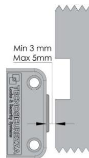
La carga máxima aplicable al pestillo no debe exceder 1KN. Contacte con Tecnosicurezza en caso de cargas mayores.
