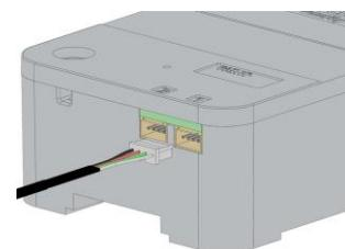
La versión Push & Pull (T4710/MP) se suministra por defecto con opción RCS en la que el cierre es activado por una señal externa (p.ej. interruptor en pestillería) y el teclado emite dos pitidos para confirmar el bloqueo seguro del cerrojo. Esto evita que el motor se active cuando la pestillería aún no se ha expandido. Se recomienda utilizar correctamente esta señal para evitar daños en el motor.
