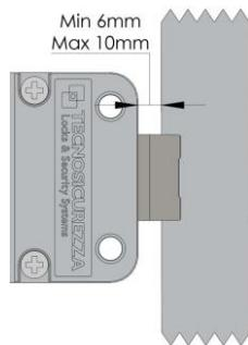
La distancia entre la cerradura LatchBolt y la barra de bloqueo debe ser de 6 mm como mínimo y máximo de 10mm.
