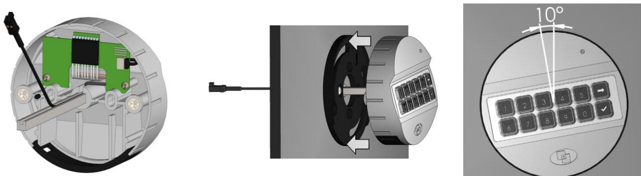
Coloque el cable de conexión dentro de la ranura del eje. Inserte el cable y el eje dentro del orificio destinado para ello en la puerta. Manteniendo el teclado en posición angulada (10:00 en punto) enganche el teclado a la placa giratoria posterior. Seguidamente, gire la botonera en el sentido de las agujas del reloj hasta las 12:00 en punto. Escuchará un clic al llegar a la posición final.
