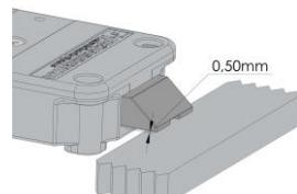
Corte el eje a la medida correcta (mida el grosor de la puerta + placa de montaje/pomo o maneta de rotación + inserción del eje en la cerradura).
