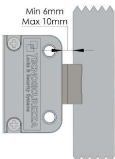
La distanza tra la cassa della serratura e la battuta deve essere compresa tra un minimo di 6 mm e un massimo di 10 mm.
