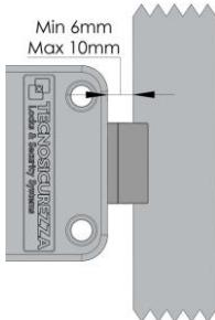
La distanza tra la cassa della serratura e la battuta deve essere compresa tra un minimo di 6 mm e un massimo di 10 mm.
