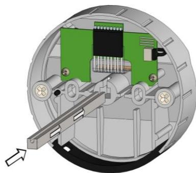
Fissare le viti (M4) e la base di montaggio posizionando quest'ultima sul lato contrassegnato "UP".
