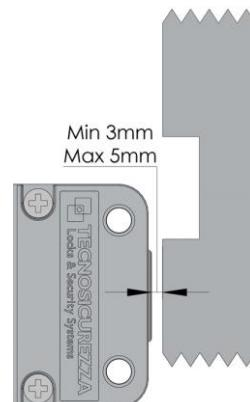
La serratura LatchBolt è appositamente studiata per poter assicurare il blocco automatico nel momento della richiusura del battente.
