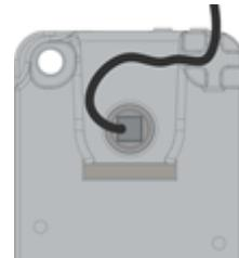
Collegare il cavo all'ingresso "1" della serratura accertandosi che sia completamente inserito e bloccato. Qualunque interfaccia di allarme o porta batteria deve essere connesso al connettore "2" della serratura. Per rimuovere il cavo, portare il connettore verso l'alto ed estrarlo con cura.
