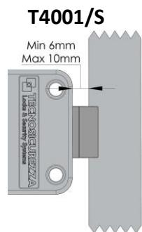
La distanza tra la cassa della serratura e la battuta deve essere compresa tra un minimo di 6 mm e un massimo di 10 mm.
