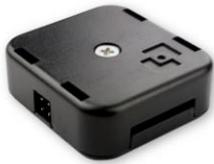
El nuevo accesorio tiene la referencia T20019/T y viene con un diseño renovado. Hay 5 puertos de comunicación, 1 tipo Molex estándar y 4 de la nueva generación Pico-SPOX, para interconectar la nueva MotorLock con toda la gama de productos existentes de Tecnosicurezza.
